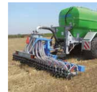
Injecteurs à lisiers Injecteurs à disques, à dents ou à charrues
